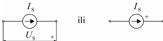
Slika 2.4. Na strujnom generatoru, tačka iz koje struja “izlazi” je na višem potencijalu od drugog priključka.
