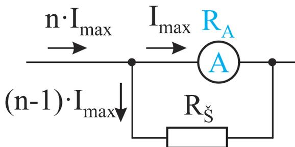
$$I_{\max} = \frac{R_{\check{s}}}{R_A + R_{\check{s}}} \cdot n \cdot I_{\max}$$
