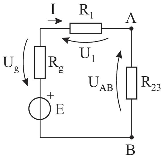
$$R_{23} = R_2 \parallel R_3 = \frac{0,2 \cdot 0,4}{0,2 + 0,4} = 0,133\ \Omega$$
