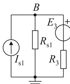
$$\left( \frac{1}{\infty} + \frac{1}{R_{s1}} + \frac{1}{R_3} \right) V_B = I_{s1} + \frac{E_3}{R_3}$$
