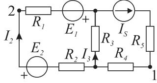
$$R_2 I_2 - E_2 + R_1 I_2 - E_1 - R_3 I_3 = 0$$
