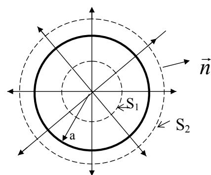
Zamišljene sferne površi  $S_1$  i  $S_2$ , na koje se primenjuje Gausov zakon radi izračunavanja  $E(r)$ .
