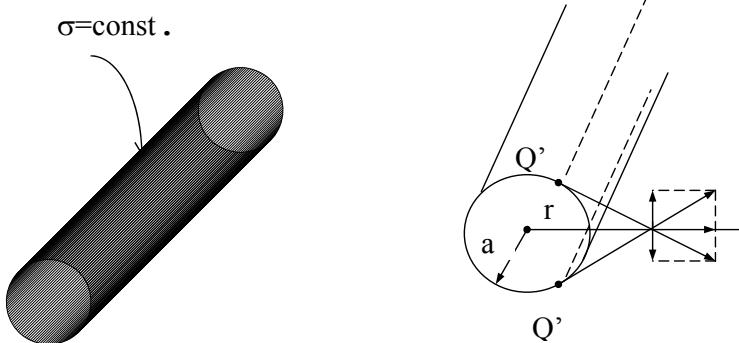
Uz dokaz da su linije polja cilindrično-simetrične raspodele naelektrisanja radijalne. Cilindrična površ se izdeli na tanke niti, paralelne osi površi (levo). Polje dve niti, simetrično postavljene u odnosu na radijus  $r$ , u ravni poprečnog preseka (desno).
