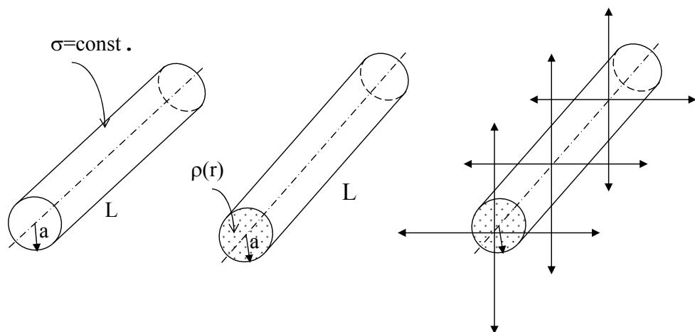
Površinska i zapreminska **CILINDRIČNO-SIMETRIČNA** raspodela naelektrisanja ( $L \rightarrow \infty$ ). Linije polja su radijalne.  $E = E_r = E(r)$ .
