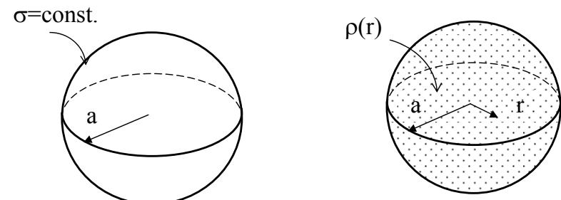
Površinska i zapreminska **SFERNO-SIMETRIČNA** raspodela naelektrisanja.
